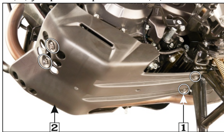
(1) Pernos placa de protección (2) Placa
