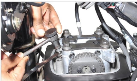
(5) Medidor (6) Tornillo de ajuste (7) Vástago de válvula (8) Tuerca de bloqueo
