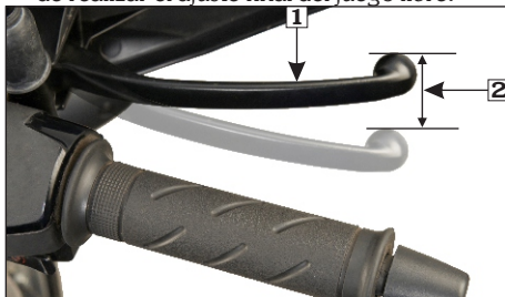
(1) Palanca freno delantero (2) Juego libre 10-20 mm
