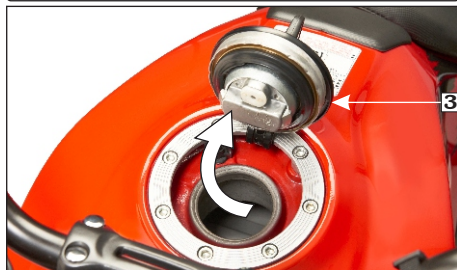
(3) Tapa tanque de combustible
