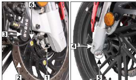
(1) Bujes lateral (2) Disco (3) Pinza (4) Tuerca del eje delantero (5) Pernos Allen laterales (6) Sensor de velocidad de la rueda
