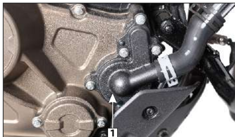
(1) Bomba de agua
