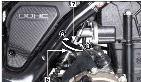
(6) Contratuerca (7) Tuerca de ajuste del cable (A) Disminuir juego libre (B) Aumentar juego libre
