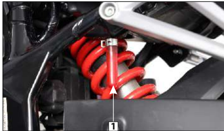
(1) Tubo de drenaje
