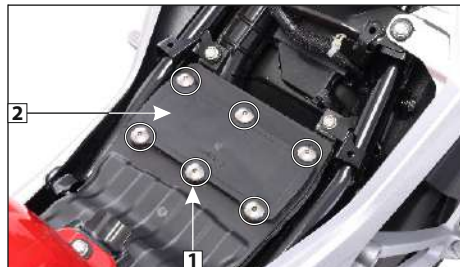
(1) Tornillos de la tapa del filtro de aire (2) Tapa del filtro de aire
